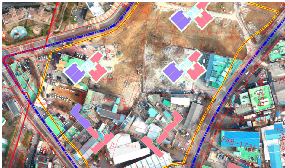
드론측량 - 도면 중첩을 통한 사전 간섭 등의 확인
